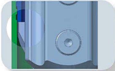
Θέση μανδάλου κατά τη διάρκεια της διάτρησης Position of latch during drilling
