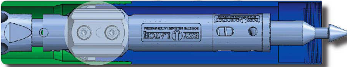
Θέση μανδάλου κατά τη διάρκεια της διάτρησης Position of latch during drilling
